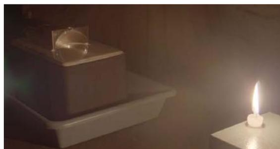
Abb. 3: Skizze (oben) und Foto (unten) des Versuchsaufbaus „Hohlspiegel im Milchbad“.
