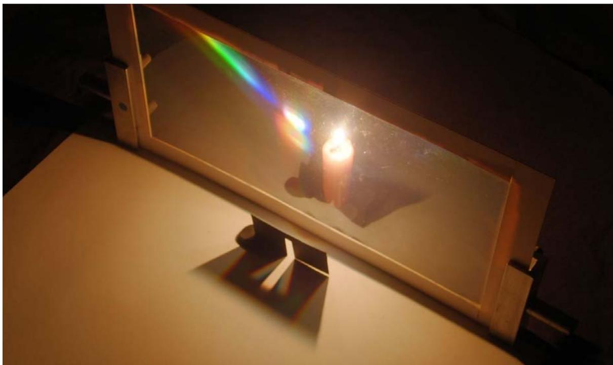
Abb. 3: Beleuchtung eines kleinen Gegenstandes durch die Gitterfolie hindurch: Charakteristisch sind vervielfachte, teils farbig gesäumte Schatten (besonders deutlich am Spalt).
