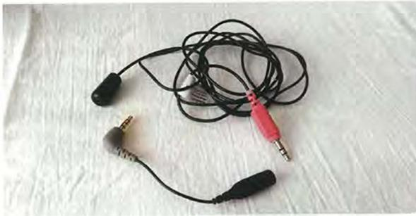
Abb. 5: Kabelgebundenes Mikrofon zum Ankleben an Kleidung (Klemme entfernt) für Kopfhöreranschluss des Smartphones (inkl. oft nötigem Adapter TRS auf TRRS), das sich gut in Hohlkörper einführen lässt
