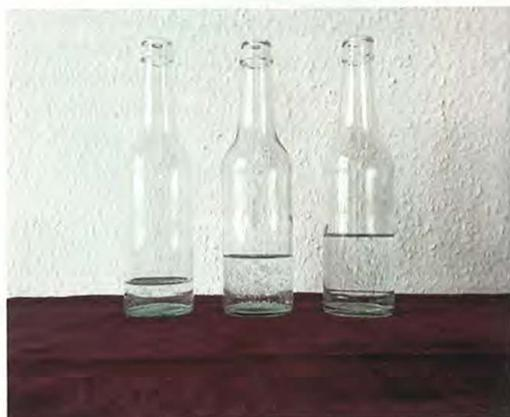
Abb. 2: Drei Glasflaschen mit unterschiedlichen Füllständen, „auf denen“ durch Anblasen drei unterschiedlich hohe Blastöne (nebst ihrer Ober-töne) erzeugt werden können
