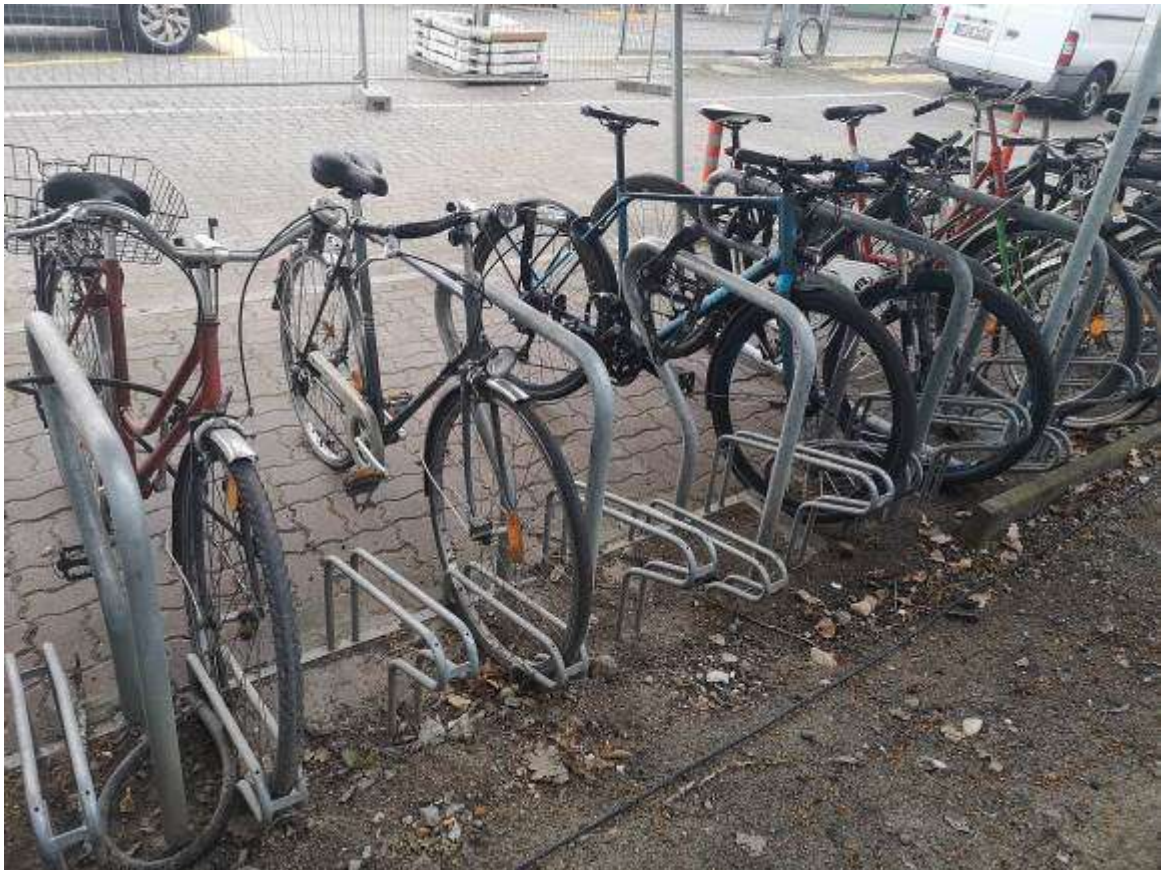
Dieser Fahrradständer gibt dem Fahrrad guten Halt. Fahrradrahmen und Vorderrad können zusammen mit einem Schloss angeschlossen werden © Mobild
